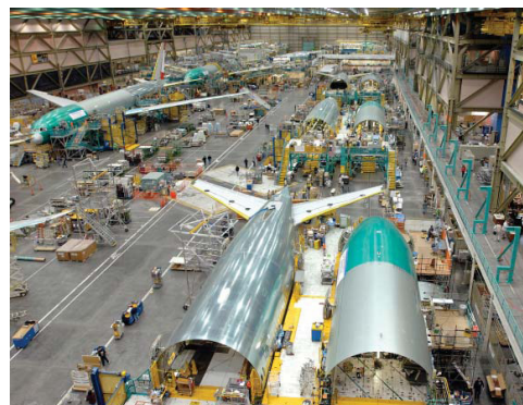
Сборочная линия Boeing-777 позволила сократить время производственного цикла, оптимизировать незавершенное производство и повысить качество.
